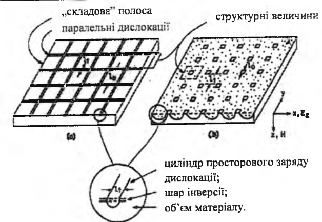
Рис. 17. Геометрична модель дислокацій невідповідності: а – для малої площі зарядженого просторового циліндра дислокацій; б – площа дислокацій є великою. l_1 – ширина області просторового заряду дислокацій, l_0 – міждислокаційна відстань [29]
