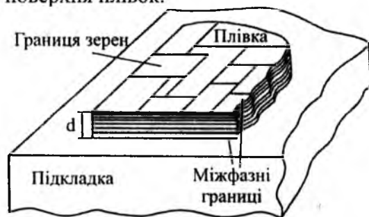
Рис. 1. Схема міжфазних і міжзеренних меж в тонкоплівковій структурі [4]
